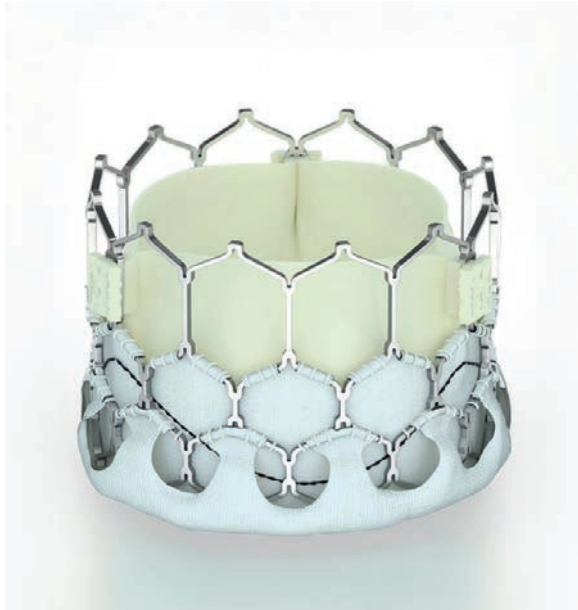
Figura 1 A: La válvula "MyVal" (Meril Life Sciences Pvt. Ltd., India) es una prótesis balón expandible compuesta por un stent de níquel cobalto, sobre el que van montadas 3 valvas de pericardio bovino con tratamiento anti-calcificación y un recubrimiento o falda de sellado exterior de PET en la zona de aterrizaje, que disminuye la posibilidad de insuficiencia perivalvular residual.
